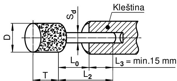
Maximální vyložení nástroje  $L_0 - 10\text{mm}$
