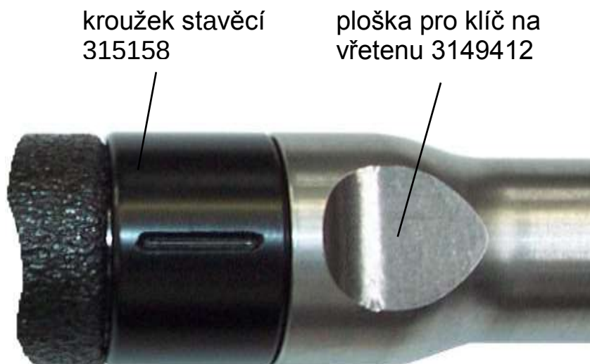
Obrázek: Poloha stavěcího kroužku 315158 s částečným výfukem
