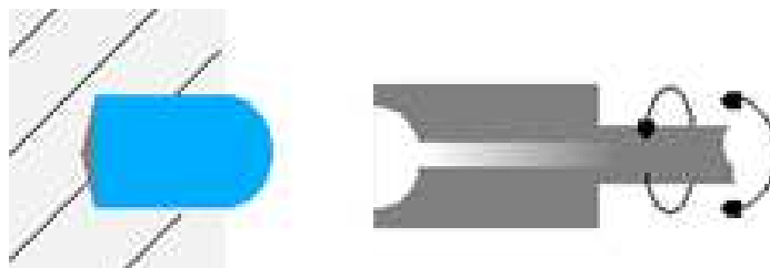
Obrázek 2 - Axiální broušení roubíků speciálním brusným nástrojem - příklad
